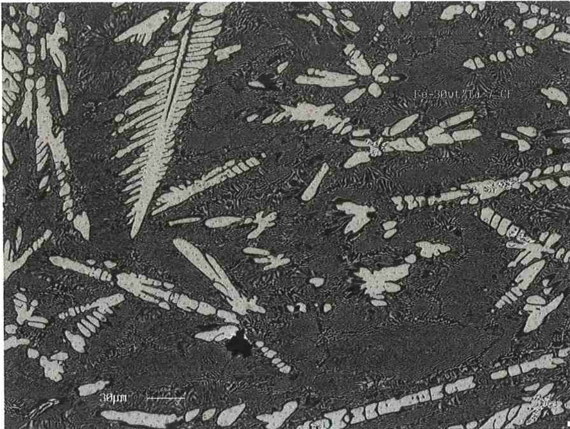
Figura 4.5 - Micrografia da liga Fe-30%Ta como fundida MEV(1000x). Sem ataque. Percebe-se que os grãos primários são mais claros, referentes ao composto intermetálico. Liga hipereutética.
