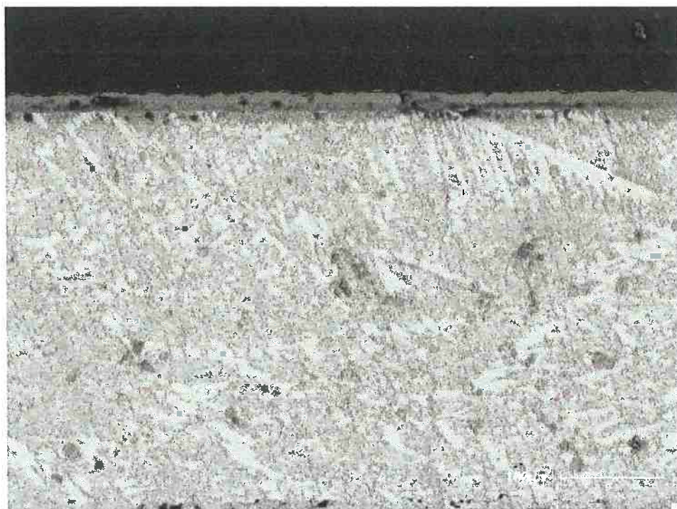
Figura 4.24 – Micrografia da liga Fe-30%Ta oxidada ao ar a temperatura de 700°C por um período de 18 horas. Sem ataque. MEV (700x).
