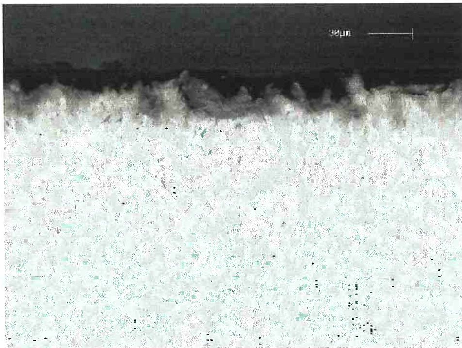
Figura 4.21 – Micrografia da liga Fe-15%Ta oxidada ao ar a temperatura de 700°C por um período de 18 horas. Sem ataque. MEV (1500x). Dificil identificação da superfície oxidada.
