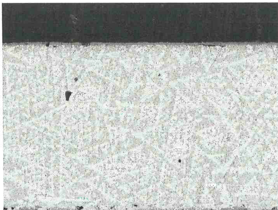
Figura 4.22 – Micrografia da liga Fe-30%Ta oxidada ao ar a temperatura de 600°C por um período de 18 horas. Sem ataque. MEV (500x).
